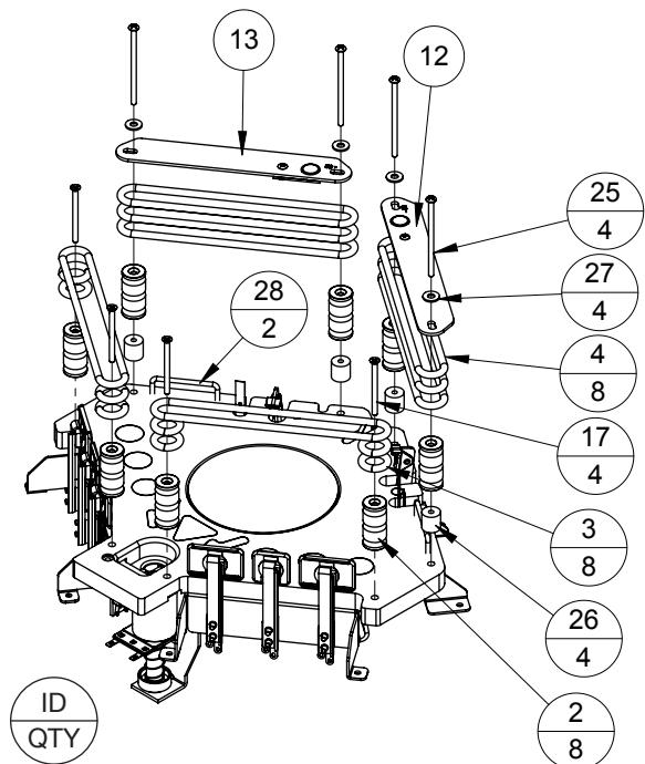
Figure 5.30.1. 500-9919-00 mini playfield assembly top view
