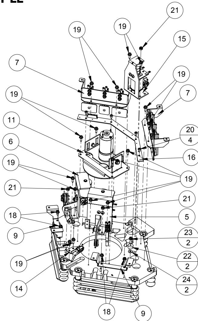
Figure 5.30.2. 500-9919-00 mini playfield assembly bottom view
