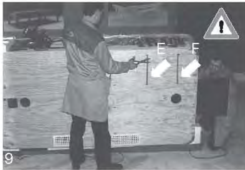
CORTAR FLEJES E-F Y ACTUAR COMO PUNTO 5-7. CUT PACKING STRIPS E-F AND ACT AS PER NO. 5-7.
