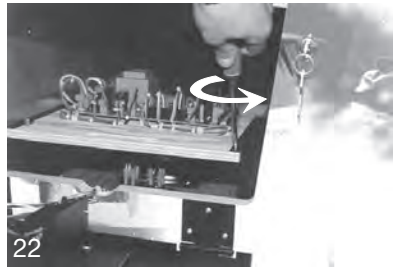
22 EXTRACCION DE C.P.U. C.P.U. WAY OUT.
