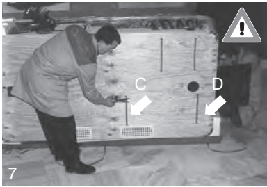
7 CORTAR C-D Y ACTUAR COMO PUNTO N° 5. CUT C-D AND ACT AS PER NO. 5.
