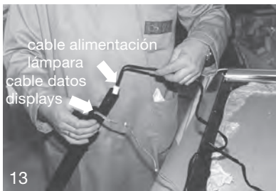
INTRODUCIR CABLES POR EL SOPORTE. INSERT WIRING THRU SUPPORT ( lamp feed wiring-display data wiring ).
