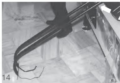
APOYO DEL SOPORTE EN EL MUEBLE s/FLECHA. SUPPORT LEANING ON CABINET ref./ ARROW.
