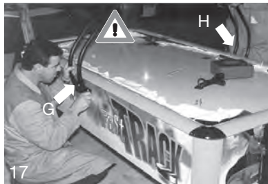
COLOCACION DE TORNILLOS POR ORDEN: 1º -G Y SUJETAR POR -H. SCREW SET-UP 1st -G AND HOLD THRU -H.
