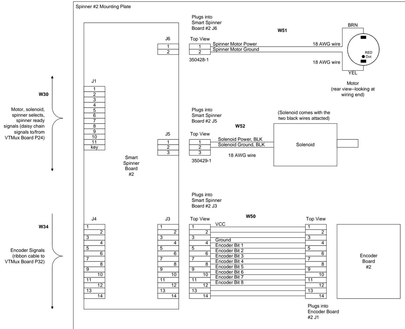
**FIGURE 9 SPINNER #2 SUBASSEMBLY**
