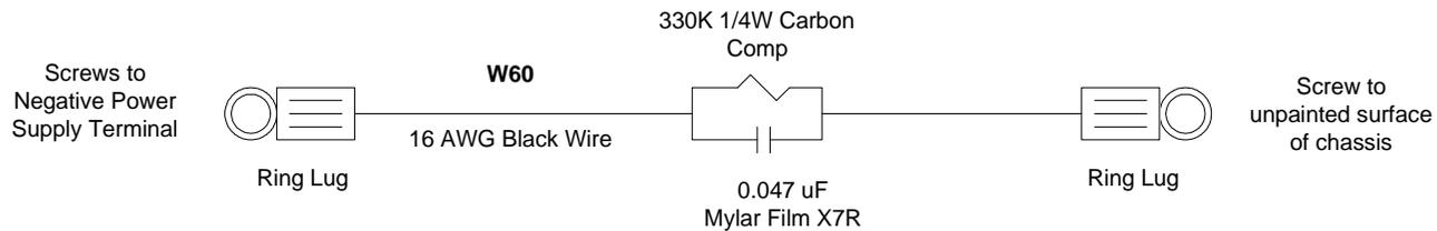
**FIGURE 26 CHASSIS GROUND**
