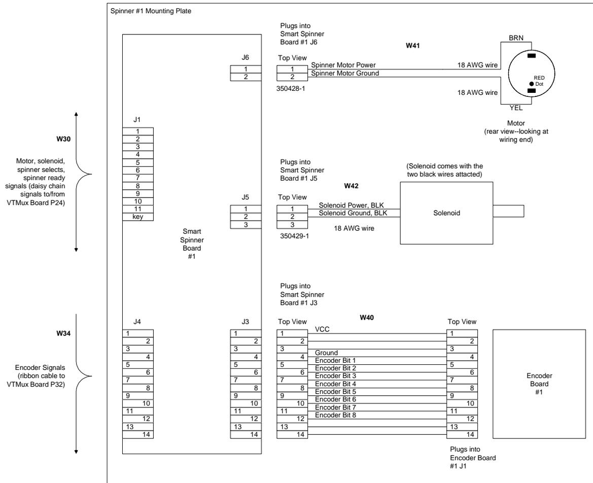
**FIGURE 8 SPINNER #1 SUBASSEMBLY**
